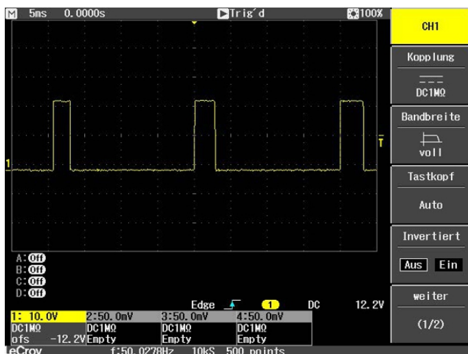
Abb. 38: Verkürzter Puls eines digitalen Ausgangs mit Last.
