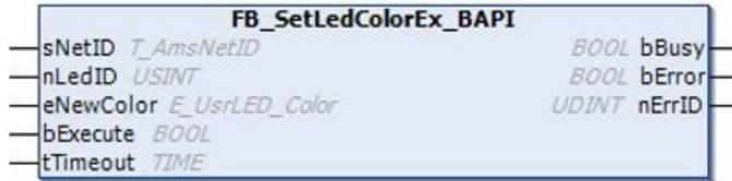
Mit dem Funktionsbaustein FB\_SetLedColorEx\_BAPI kann die User-LED auf Industrie-PCs und Embedded-PCs mit BIOS-API-Unterstützung geschaltet werden. Die LED-Farbe wird über eine steigende Flanke an bExecute und die Farbe eNewColor geschaltet. Für Geräte mit einer User-LED wird über nLedID = 0 die User-LED gewählt (Standard-Wert ist 0). Für Geräte mit mehreren User-LEDs wird über nLedID = 1 die U1-LED bzw. über nLedID = 2 die U2-LED gewählt.
