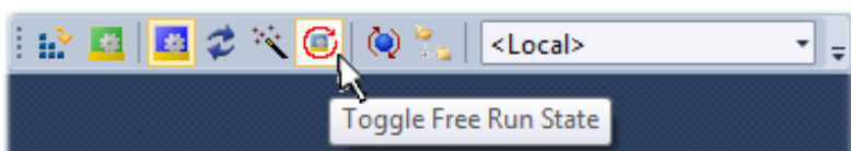
Abb. 92: TwinCAT kann auch durch einen Button in diesen Zustand versetzt werden (TwinCAT 3)
