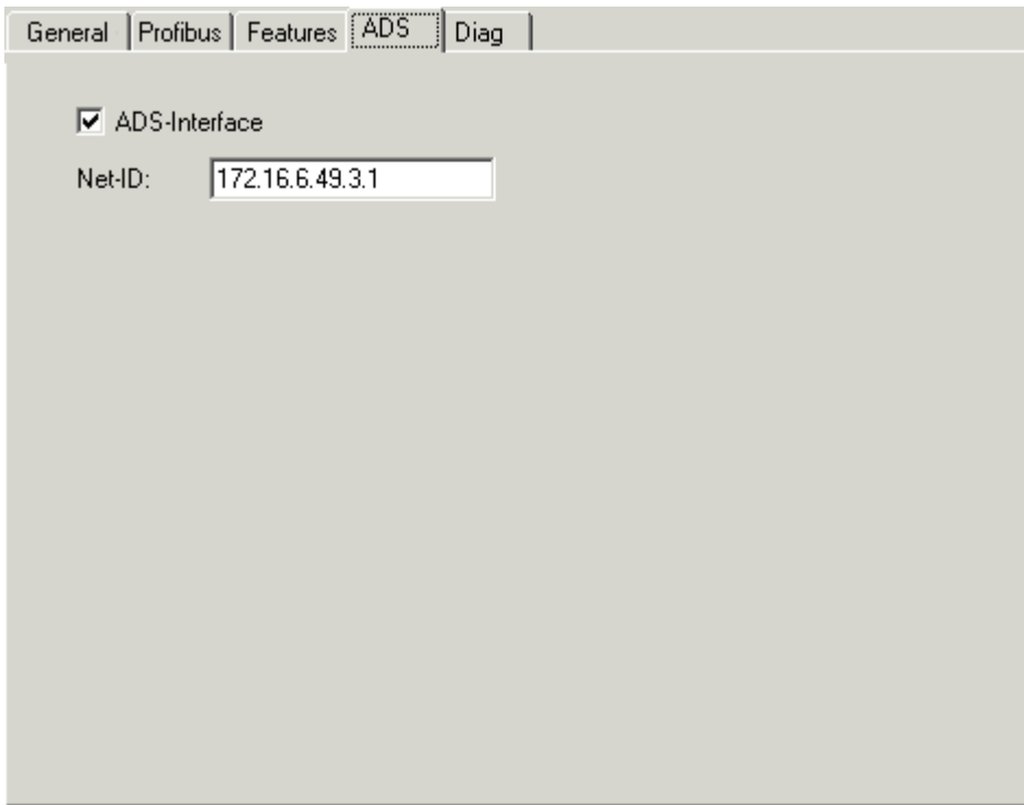
附图 124: DP 主站的ADS 选项卡: 启用 ADS Interface 并输入 NetID
