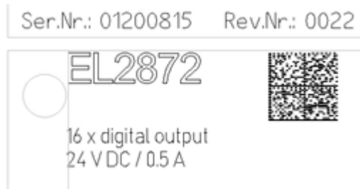
Abb. 1: EL2872 mit Revision 0022 und Seriennummer 01200815
