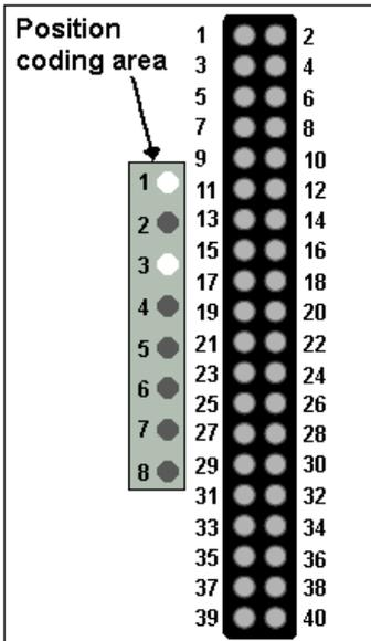
Fig. 20: Pin coding; sample: digital input modules
